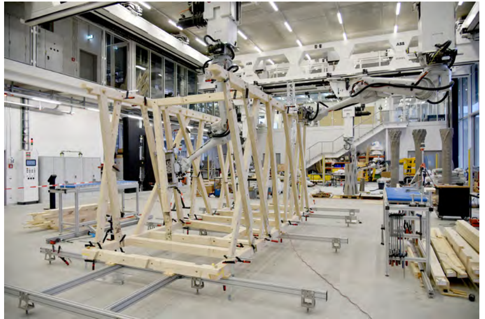
木造骨組みモジュールは、ETHチューリヒのロボティック・ファブリケーション・ラボでプレハブ工法を用いて建設された。 © Gramazio Kohler Research, ETH Zurich
